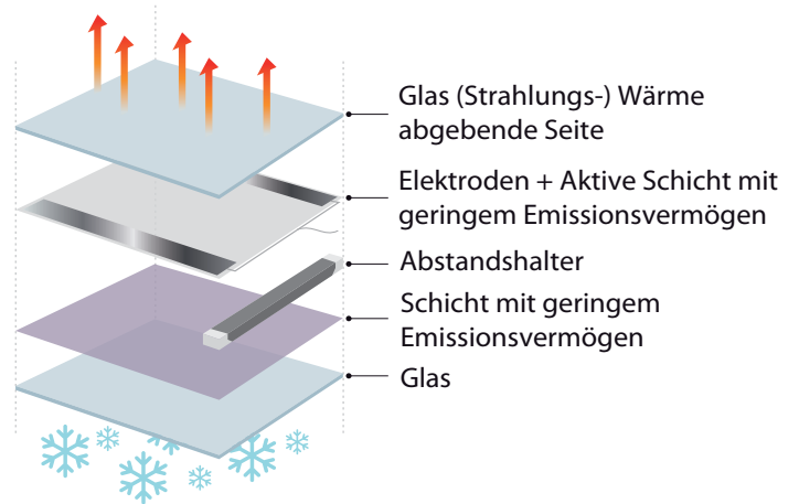
SCHEMA AUF DER BASIS EINER DOPPELVERGLASTEN SCHEIBE
